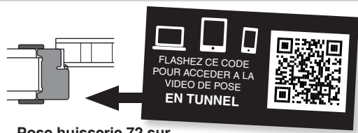
Pose huisserie 72 sur cloison de 72mm, avec couvre joint.
