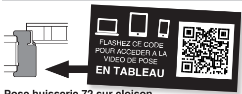
Pose huisserie 72 sur cloison de 50mm ou huisserie 90 sur cloison de 72
