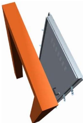
Il s'agit de retirer les ancrages sur la distance nécessaire pour encadrer dans le trou et de fixer avec du ciment.
