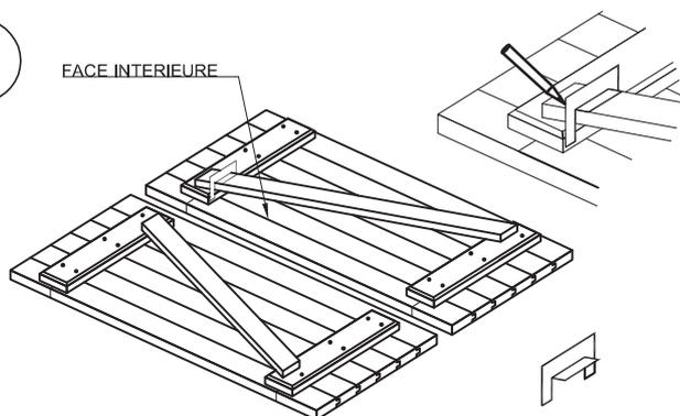
METTRE EN POSITION L'ECHARPE ET REPERER L'ANGLE DE COUPE A L'AIDE DU GABARIT FOURNI
