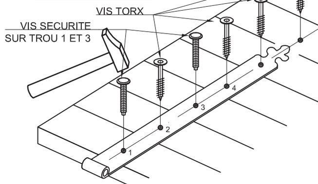
FIXER LES VIS DE SECURITE A L'AIDE D'UN MARTEAU
