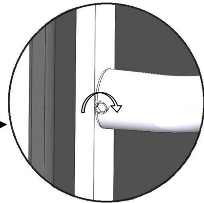
Placez les béquilles sur le portail (béquille réduite coté pilier) et serrez la vis à l'aide d'une clé 6 pans de 3.
